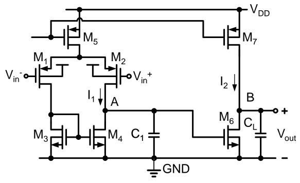
$$A_{V1} = -g_{m1}R_{o1} = -g_{m1}(r_{ds4} // r_{ds2})$$
